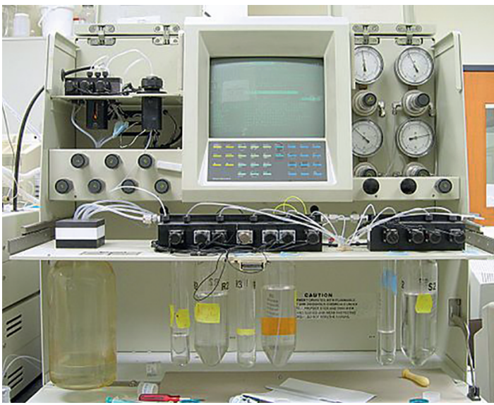
Figure 1. Séquenceur de protéines Beckman-Coulter Porton LF3000G, automatisant la dégradation séquentielle d'Edman, dans la limite d'une cinquantaine d'acides aminés (image Wikipedia commons).
