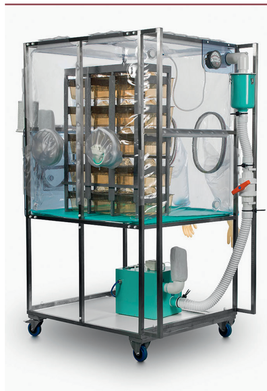
Figure 4. Système d'enceinte pour l'élevage de souris axéniques utilisé aujourd'hui.
